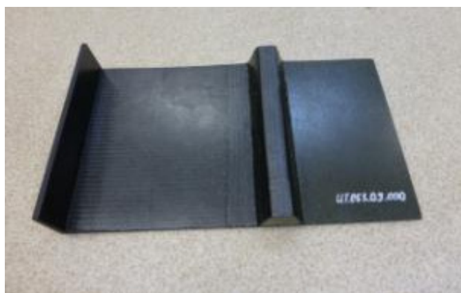
Рис. 10. Образец из ПКМ с внедренными дефектами
